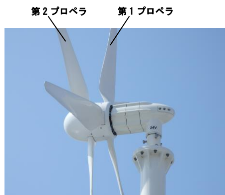
前後のプロペラの動力の結合機構
