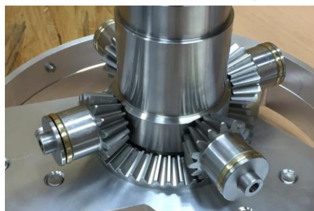
前後のプロペラの動力の結合機構
